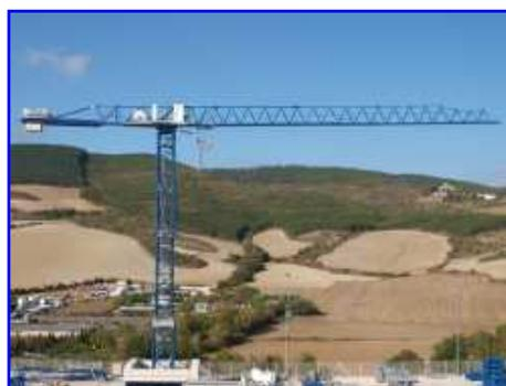
El sistema de doble carro de estas grúas es similar al usado con éxito en las series LC1100 y LC2100, aunque ha sido adaptado a cargas máximas de 12 toneladas. El conjunto carro-gancho, con los reenvíos preinstalados, viene en un bastidor que facilita su montaje, transporte y almacenaje.
