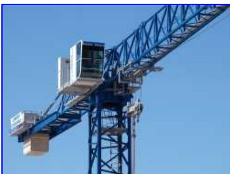
Los mecanismos de elevación incluyen el sistema *Effi-Plus* de Linden Comansa, que mejora hasta un 70% la velocidad de elevación y descenso de cargas ligeras. De esta forma se incrementa hasta un 27% la productividad en las operaciones de elevación, sin aumento de potencia ni mayor consumo de energía.
